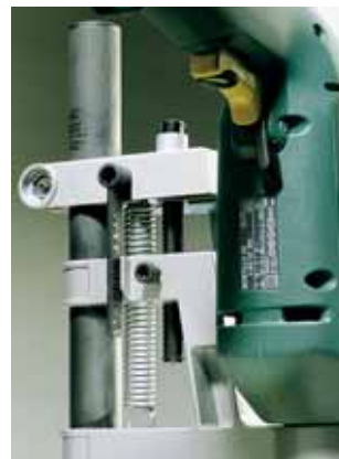
a furatmélységet a mélységállító állítja
