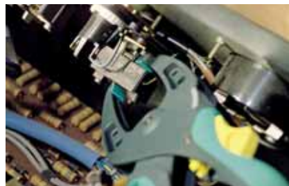
a hosszú, keskeny szorítókarok optimálisak még a szűkös helyeken is
